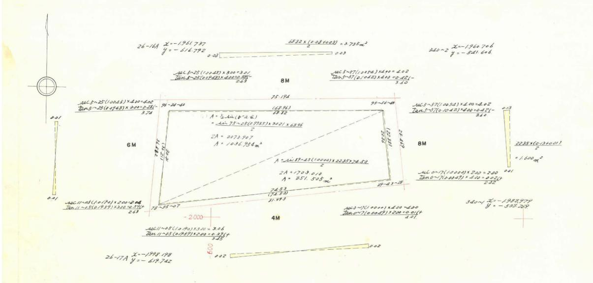
合計面積 剪除面積 ブロック面積 -1.600 + 3.785 = 2.185 1036.951 + 851.505 + 2.185 = 1890.64m<sup>2</sup> 2.23 + 2.50 + 2.13 + 150 = 8.36m<sup>2</sup> 1882.28 m<sup>2</sup>
